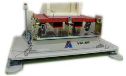
多軸振動発生機 WTS シリーズや大型輸送試験 VSR シリーズのユニットとしても Type-R 相当品が複数台使用されています
