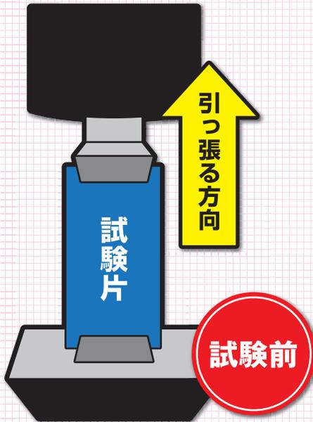
荷重で制御していますので、試験体が引っ張られて伸びても制御器は荷重しか見ていませんので目標値に向かって動きます。
